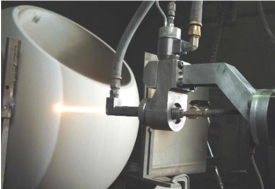
粉末等离子堆焊在冶金轧制工具制造行业的应用：冶金轧制工具中存在多种易损件，由于粉末等离子堆焊为堆焊复合材料提供了方便的手段，因而显示了独特的优越性，例如无缝钢管轧顶（顶头），采用该工艺在其受高温磨损的表面，堆焊含碳化物的高温耐磨耐热疲劳合金，明显的提高使用寿命。对要求有特殊表面性能的轧辊，或磨损相当严重的易损件，采用粉末等离子堆焊工艺，或敷面采用粉末等离子堆焊工艺，对制造特种高合金硬面层，提供了便捷的手段。广东等离子堆焊技术等离子堆焊的堆焊面平整光滑，致密度高。
