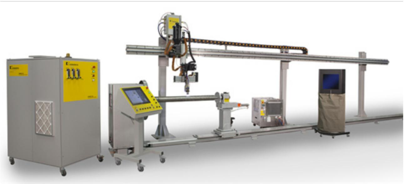
等离子堆焊是什么？这一项技术出现之后，使得堆焊层组织变得更加紧密，其实这一款产品的确会利用等离子弧以及合金粉末来共同完成，融化的过程融化之后，自然可以将两个单独的零部件连接在一起，对于连接效率产生了提升的作用，而且中间的连接处看起来更加自然，不会出现难看的接痕。等离子粉末堆焊是以等离子弧作为热源，应用等离子弧产生的高温将合金粉末与基体表面迅速加热并一起熔化、混合、扩散、凝固，等离子束离开后自激冷却，形成一层高性能的合金层，从而实现零件表面的强化与硬化的堆焊工艺。等离子粉末堆焊技术特点：节能易操作，维修维护容易。广东等离子堆焊技术
