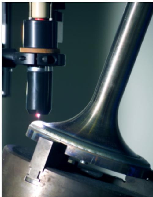
粉末等离子堆焊工艺已应用于工业制造业的多个领域, 主要目的在于获得有特定性能(耐磨、耐蚀、耐高温等性能)的合金硬面层。从应用角度有以下分类:按工件堆焊面的几何形状分类。主要分为:园平面、园锥面、园柱面、园柱螺旋面、平面线段或平面等。针对不同类型的工件, 在工艺控制程序上有所区别。对于复杂的平面线段(连续或不连续的直线段或曲线段), 要实现全自动堆焊, 就要采用数控系统。对同一类型工件, 在几何尺寸上相差甚大者, 则要选择相适应的机型。按工件所属的制造行业分类。根据目前的应用情况, 主要有:阀门制造行业、气门制造行业、冶金轧制工具制造行业、石油机械行业、煤矿机械行业、电力机械行业等等。随着应用范围的扩大, 将会有更多的制造行业在产品的修造中采用粉末等离子堆焊技术。
